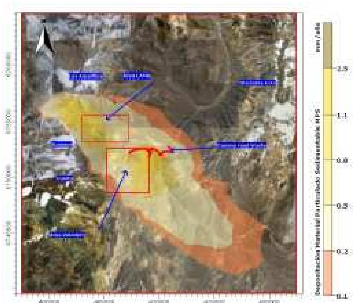
1FIGURA 4.3: DISTRIBUCIÓN ESPACIAL DE LA DEPOSITACIÓN DE MPS EN CONCONTA (MM/AÑO)
